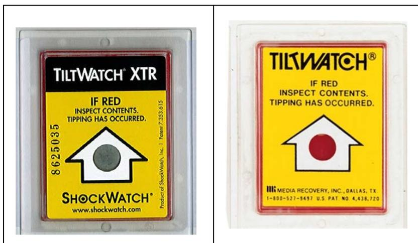
Abbildung 2: TiltWatch-Aufkleber: links i.O. / rechts nach Umkippen
