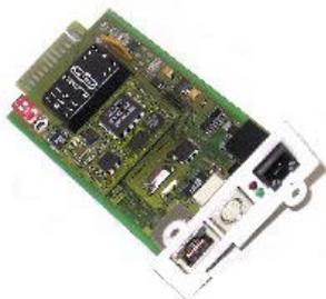
Die interne SNMP-Steckkarte kann in einem entsprechenden Steckplatz der **USV** eingesetzt werden. Dieser Adapter kommuniziert mit der USV via serielle Schnittstelle und ermöglicht einen den Shutdown von mehreren Servern ohne zusätzliche SNMP Management Software.
