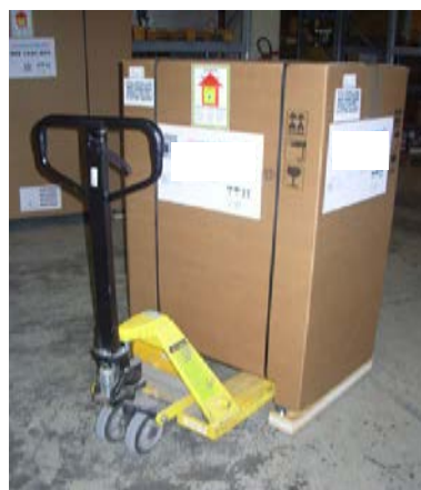
Abb. 1.5.1 Boden muss der Belastung standhalten
